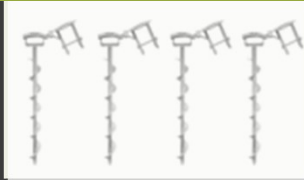
Zestaw kotew gruntowych wkręcanych 2 stałe 2 ruchome
