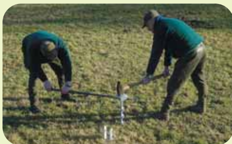
Bei steinigem Boden, gleichzeitig drehen und schlagen.
